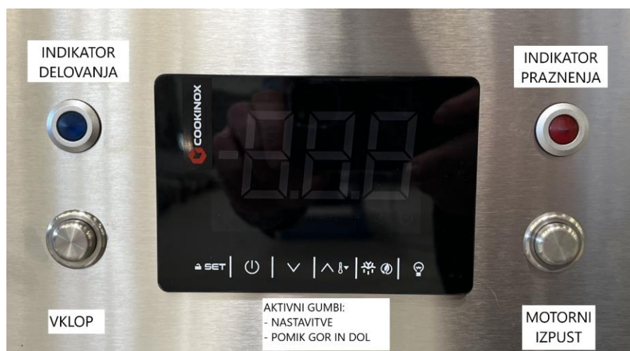
Slika 5: Stikalna plošča z motornim izpustom
